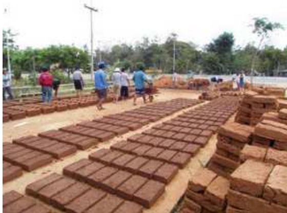
ภาพที่ 4 การทำอิฐดินดิบ ที่มา : นรินาม. 2554ง.
